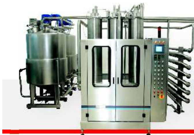
Equipo elaborador continuo de pulpas de frutas, mermeladas y salsas. Equipment for continuous production of fruit pulp, jam and sauce.
